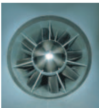
羽をカーボンコンポジットにした主送風機
