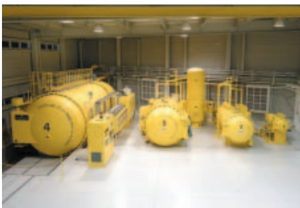
カーボンコンポジットを焼成するオートクレーブ
