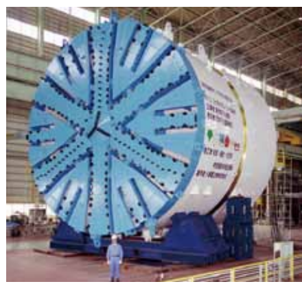
直径10.3m 主さ1,000tのシールドマシン (写真/前田建設工業株式会社)
