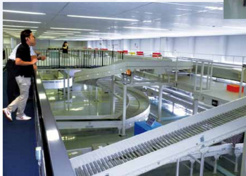
大量の商品を高速で自動的に仕分ける「サーフィンソーター」
