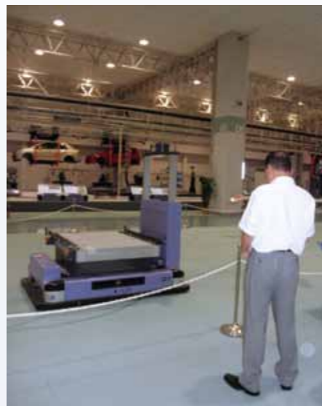
レーザーガイド方式を採用した全方向移動型無人搬送車
