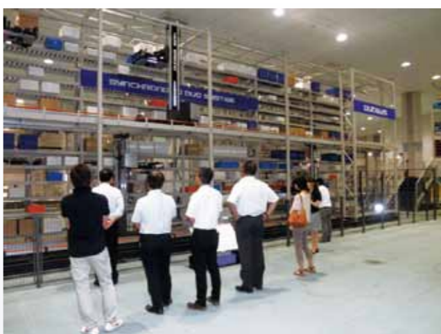
2基のクレーン車がすれ違い走行して、1時間に2,200ケース以上を処理できる保管・仕分けシステム「DUOSYS」
