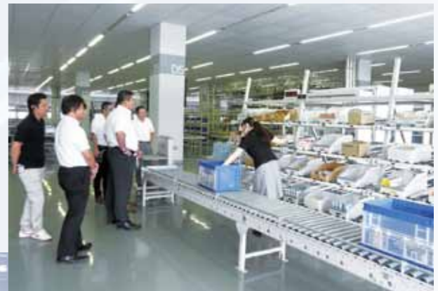
棚などに取り付けられたデジタル表示器の指示に従って、商品を積み取っていくデジタルピッキングシステム
