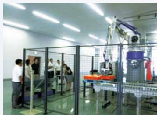
商品をパレットに積上げたり下ろしたりするパレタイジングロボット
