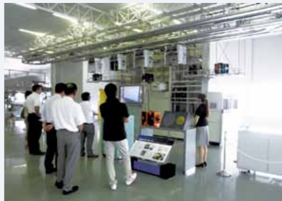
軌道式天井走行台車がウエハ専用の容器を高速搬送する、半導体工場向けのクリーン搬送システム
