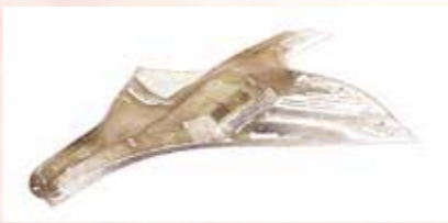
起工測量で得られた地形の点群データ
