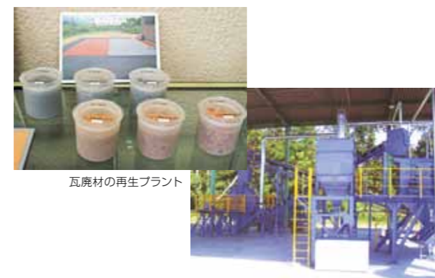
駐車場や歩道、外構などに利用される瓦廃材を再利用した舗装材
