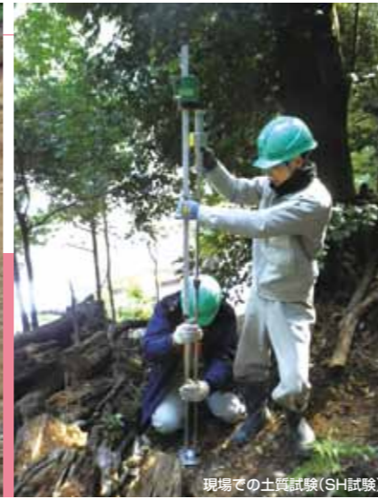
現場での土質試験(SH試験)
