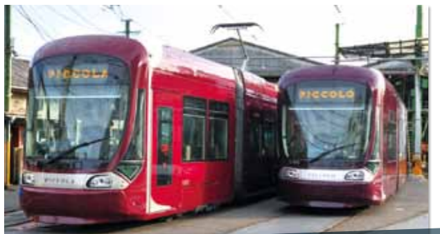
平成25年2月15日から営業運行を開始したワンマン仕様の完全超低床車両
