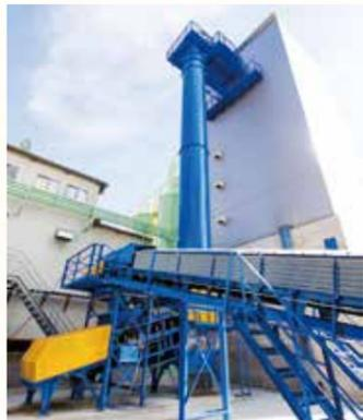
材料をプラントの最上階まで運び上げる垂直ベルトコンベア
